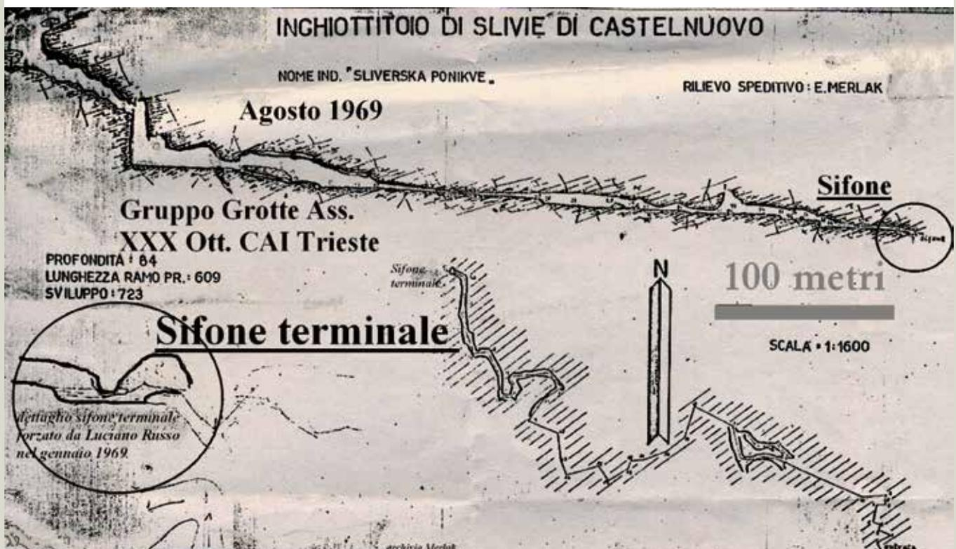
*Rilievo speditivo e particolari del sifone terminale dell'inghiottitoio di Slivje (1967-1969).*
